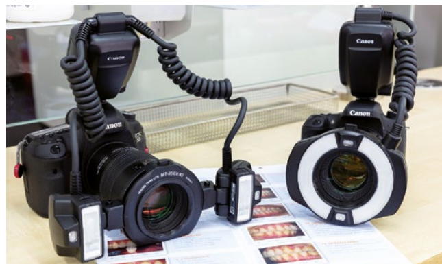
Afb. 6 De flitsers van de ringflitser zitten dicht bij de lens waardoor er een vlakke belichting ontstaat en bij portretten rode ogen kunnen ontstaan.
