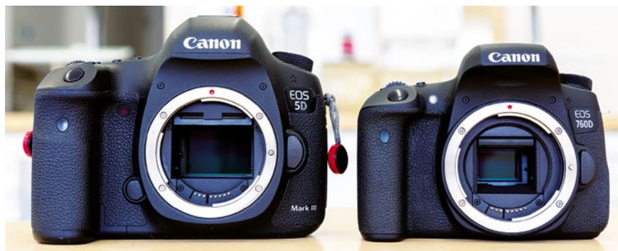
Afb. 4 Het verschil in sensor grootte tussen een fullframecamera en een cropsensorcamera.
