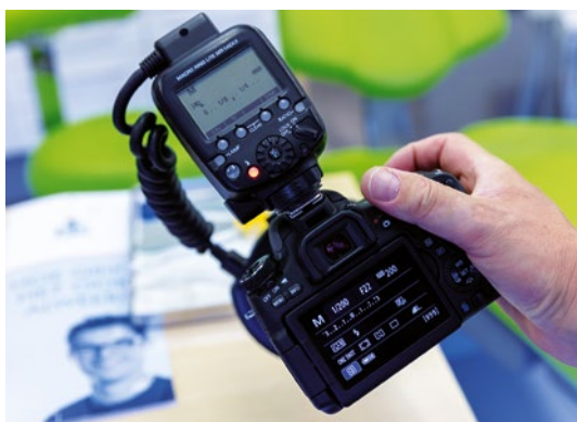
Afb. 7 Een volledig manueel ingestelde camera en flitser voor het maken van intraorale opnamen.
