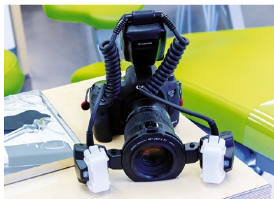
Afb. 9 Voor de flitsers worden softboxjes geplaatst om een zachtere belichting te krijgen.
